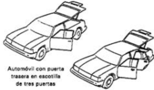
Figura 2.5. He aquí las carrocerías de los automóviles con portón trasero de tres y cinco puertas.
